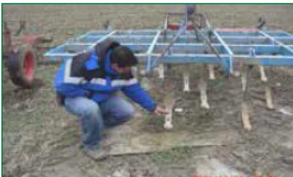
Produktionsmanager Fernando Tinoco zeigt die Arbeitstiefe am Grubber.
