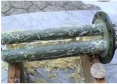
Die Heizrohr-Unterseiten waren praktisch frei von Kalkablagerungen und auf der Oberseite waren diese so luftig und locker, dass sie mit dem Finger weggewischt werden konnten! Dies alles bei einer Wasserhärte von ca. 43 °fH französischer Härte (= ca. 24 °dH) und bei einer Betriebstemperatur von ca. 58 °C.
